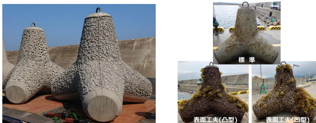
図 4-1-2 表面形状を工夫したJブルーコンクリートブロック
