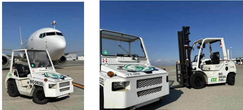
図 2-1-3 実証実験で使用するトローイングトラクター（左）とフォークリフト（右）
