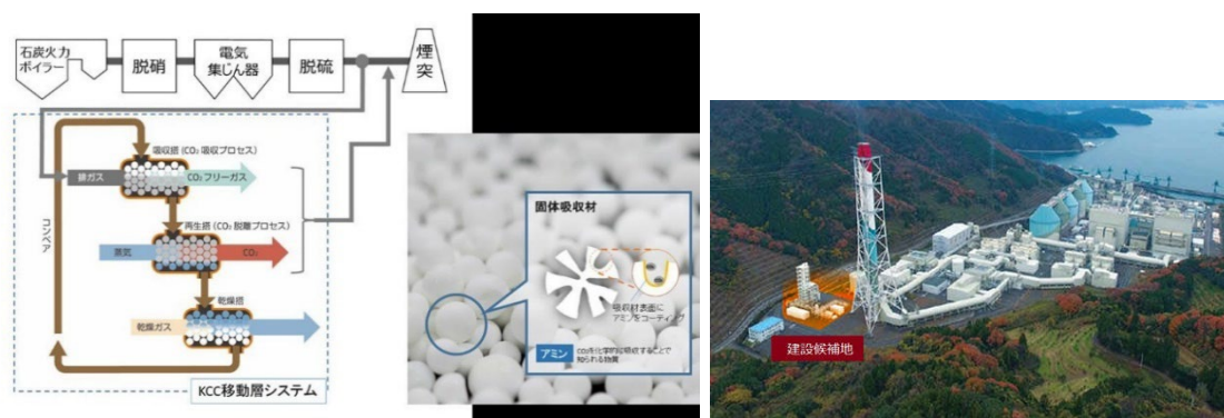
図 19. 左・中；実証試験のフロー 右；舞鶴発電所内パイロットスケール試験設備の設置イメージ 出典：川崎重工業ニュースリリース
