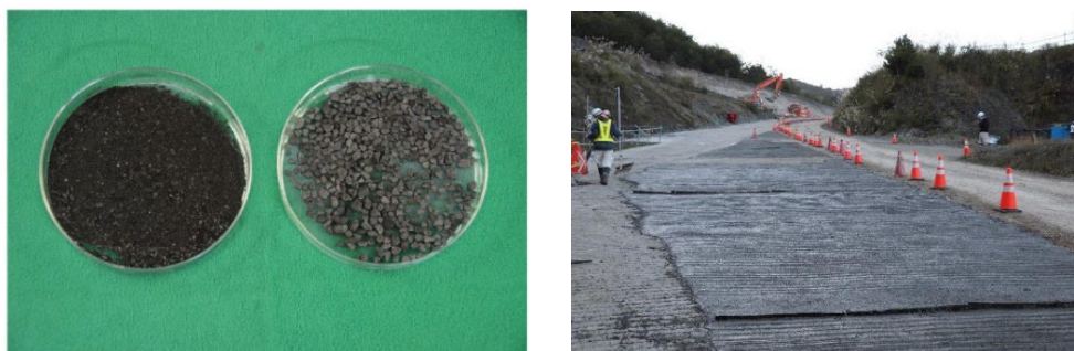
図 24. 左：粉状および粒状のバイオ炭 右：実工事への適用
