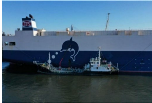
図 21. バイオ燃料の供給を受ける自動車運搬船と供給を行う燃料供給船
