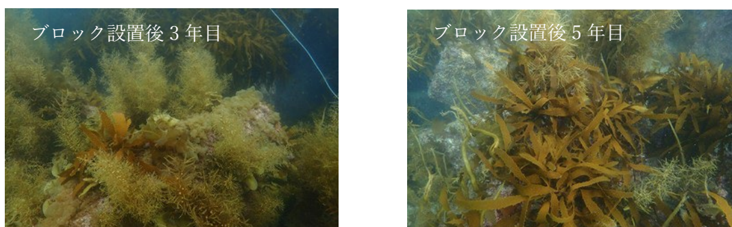
図 28. 福岡県北九州市若松区における J ブルーコンクリートブロックへの海藻付着状況例
