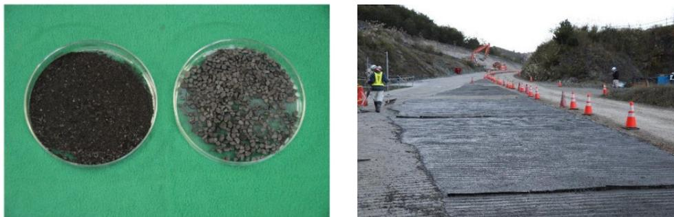
図 24. 左：粉状および粒状のバイオ炭 右：実工事への適用
