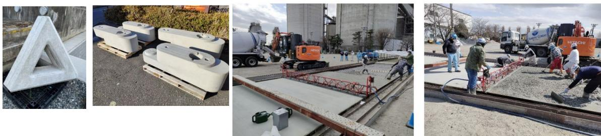
図 26. 左；カーボキャッチ・スラリーを用いて製造した消波ブロック
