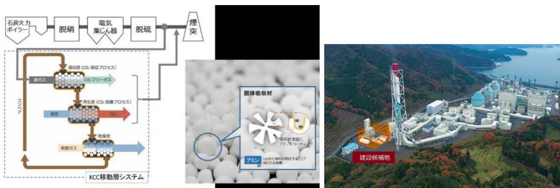
図 19. 左・中；実証試験のフロー 右；舞鶴発電所内パイロットスケール試験設備の設置イメージ
