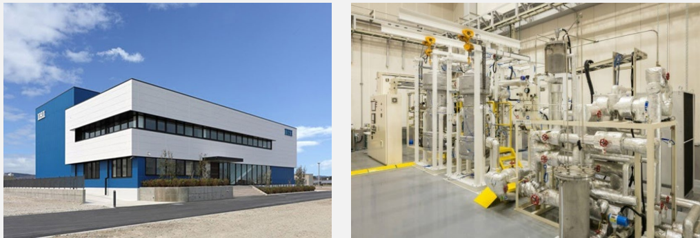
図 16. そうまラボ（左）と同所に設置された 12Nm 3 /h 規模のメタネーション設備(右)
